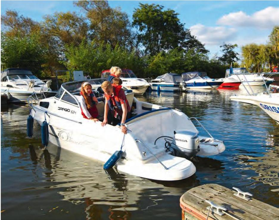
**RÜCKWÄRTS ANLEGEN** Sind die Fender ausgebracht, kuppelt man im Standgas kurz rückwärts ein und dann wieder aus. Dabei bleibt die Gashand am Hebel und die Lenkhand am Steuer (unten). Durch wiederholtes kurzes Ein- und Auskuppeln bewegt sich das Boot langsam an den Liegeplatz. Die zweite Person befestigt (belegt) die Leinen am Boot und steigt (mit den Leinenenden) erst auf den Steg, wenn das Boot komplett zum Stillstand gekommen ist.
