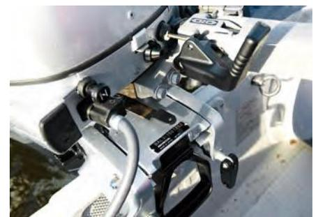
**DRAUF UND DRAN** Im mobilen Einsatz wird der Motor mit Knebelschrauben (Mitte) befestigt. Tragegriffe (oben) erleichtern den „Landgang“, funktionelle Bedienelemente die Handhabung.
