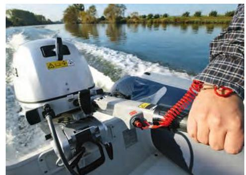
**EINER FÜR ALLE** Handstartmodelle mit Pinnensteuerung bieten den Vorteil der einfachen und schnellen Montage. Wichtig ist, dass Bedienelemente wie Starter (links), Getriebeschalthebel (mitte), Pinne und Quickstop gut platziert und leichtgängig sind.
