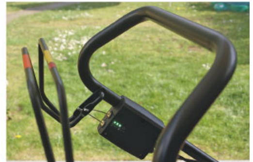
Die Akku-Ladeanzeige am Schieberholm. Der hintere Hebel schaltet den Antrieb zu
