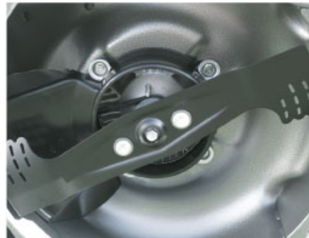
Das Schneidmesser ist gut zugänglich und kann selbstständig getauscht werden
