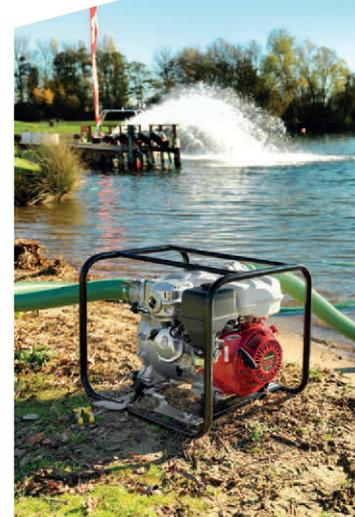
Für alle Honda-Wasserpumpen wird bleifreies Benzin benötigt.
