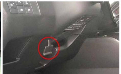
**Öffnen der Heckklappe von innen**
