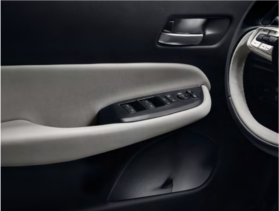
TÜRGRIFF/-FACH-BELEUCHTUNG Diese LED-Beleuchtung für die Türverkleidungen wird durch Einschalten der Zündung aktiviert. Die LED-Leuchten in den Türgriffen und in den Türfächern erzeugen eine angenehme Atmosphäre im Fahrzeuginnern.
