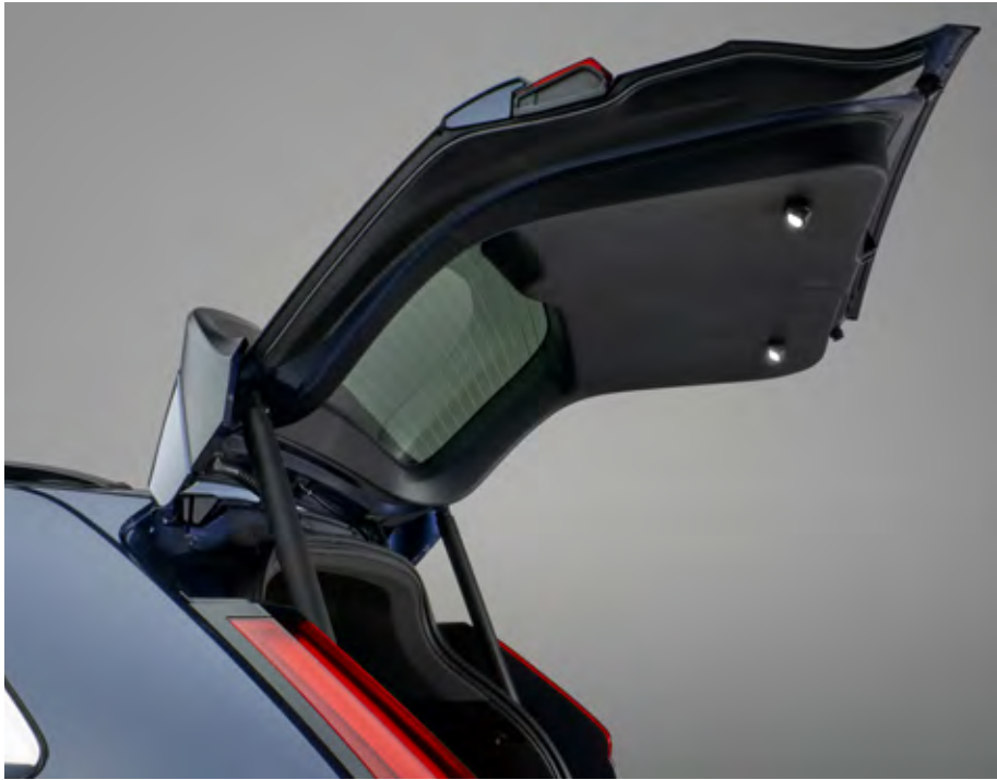
HECKKLAPPENBELEUCHTUNG Die Heckklappenbeleuchtung wurde entwickelt, um den Komfort und die Sicherheit zu erhöhen, indem sie nicht nur den Kofferraum, sondern auch den Bereich hinter dem Auto erhellt. Die LED-Leuchten an der Innenseite der Heckklappe sorgen für gute und gleichmäßige Ausleuchtung des Kofferraums – selbst bei voller Beladung.
