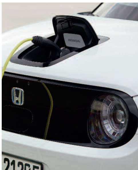
Ladeanschluss in der Haube: Bei Regen soll das Wasser ablaufen, verspricht Honda.
