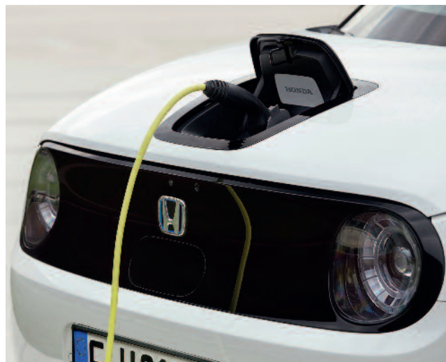
Per DC-Schnellladung benötigt der Honda e 30 Minuten für 80 Prozent Akku-Kapazität.
