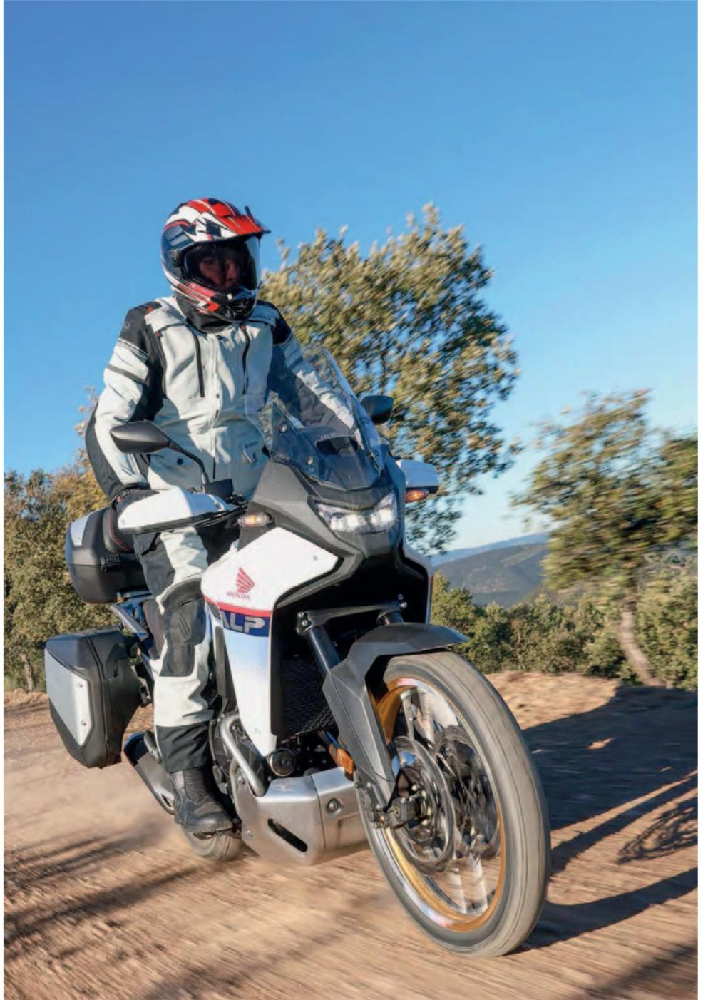
Vor allem aber bekommt die überarbeitete Honda XL750 Transalp neu abgestimmte Federelemente, an denen primär ein Federbein mit mehr Progression und Dämpfung die Balance des Motorrads gerade rückt. Jetzt schaukelt nichts mehr, die Front und das Heck federn und dämpfen tatsächlich in trauter Harmonie. Vor allem die Telegabel der Honda zeigt beim Bremsen, dass Transalp
