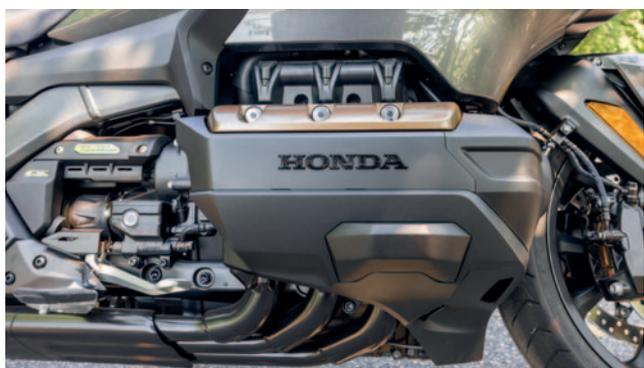
**Da steckt Leistung drin:** Maximal 170 Newtonmeter Drehmoment bei 4.500 Umdrehungen pro Minute entwickelt der blitzsauber verpackte Sechszylinder-Boxermotor der GL1800.
