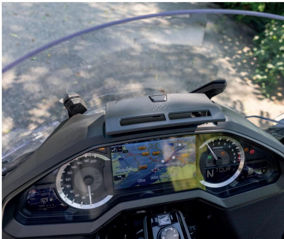
*Klare Sache: links und rechts Rundinstrumente, in der Mitte ein großes TFT-Display, das exakt und gut ablesbar die Routenführung anzeigt (selbst wenn es hier ein wenig spiegelt).*
