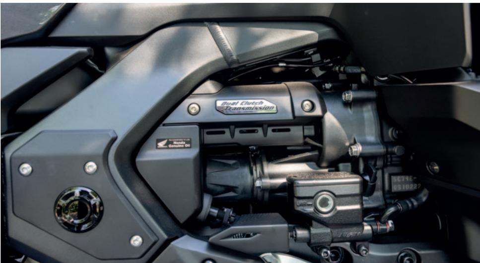
Da steht es geschrieben: „Dual Clutch Transmission“. Als einziges der zahlreichen DCT-Modelle von Honda hat das Doppelkupplungsgetriebe der Gold Wing sieben statt sechs Fahrstufen.
