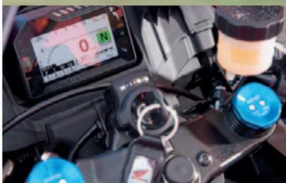
*Hochauflösendes Display mit zwei unterschiedlichen Layouts, voll einstellbare Showa-Gabel mit guter Dämpfung.*
