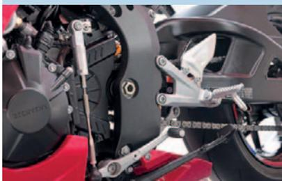
Der optimierte Brückenrahmen bildet eine der größten Veränderungen, auch die entschärfte Ergonomie (tiefere Rasten) funktioniert.
