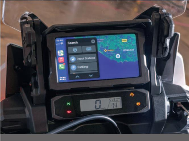
*Honda hat extra zwei Anzeigeelemente spendiert, damit die ganze Fläche des TFT-Displays für Navigation und Multimedia zur Verfügung steht. Die vielen Köpfe links lassen teilweise intuitiv die Bedienung zu, ein kurzer Blick ins Handbuch schadet nicht.*
