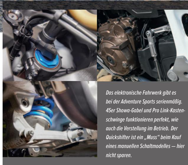
Das elektronische Fahrwerk gibt es bei der Adventure Sports serienmäßig. 45er Showa-Gabel und Pro Link-Kastenschwinge funktionieren perfekt, wie auch die Verstellung im Betrieb. Der Quickshifter ist ein „Muss“ beim Kauf eines manuellen Schaltmodells – hier nicht sparen.
