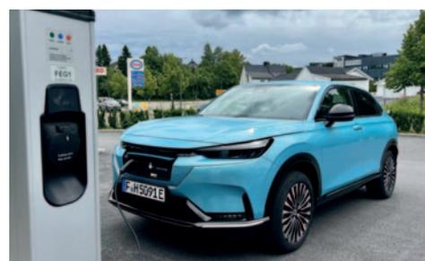
*Die Ladeanschlüsse liegen beim Honda e:Ny1 mittig in der Frontmaske. 1 kW (dreiphasig) bei Wechselstrom und 78 kW über CCS.*
