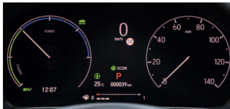
Überschüssige Leistung des Verbrenners geht in den Akku, der auch beim Bremsen geladen wird.
