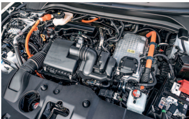
Die beiden E-Motoren haben mit 131 PS mehr Power und mit 253 Nm fast doppelt so viel Drehmoment wie der 1.5er-Benziner, der 107 PS leistet und 131 Nm auf die Kurbelwelle stemmt.
