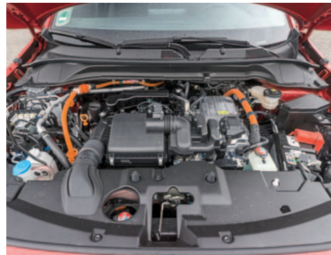
Entweder oder: Meist treibt der Elektromotor die Vorderräder direkt an, manchmal auch der Benzinler – aber nie beide zusammen.
