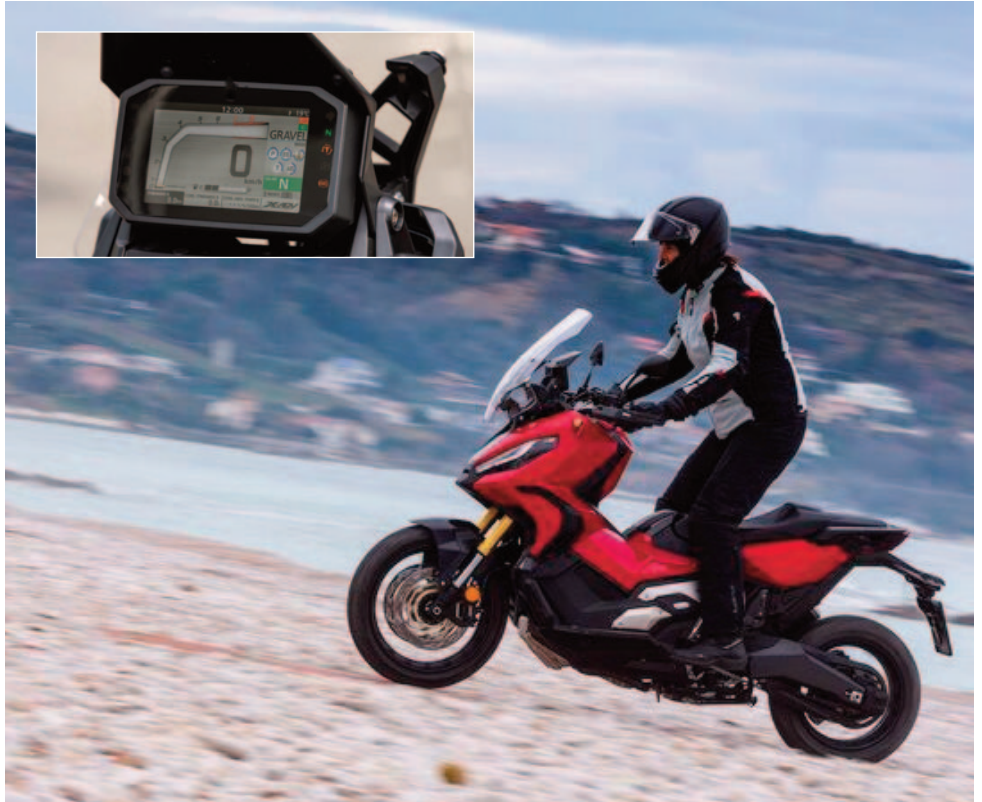
Sogar ein Gravel-Modus fürs Gelände ist an Bord. Die Traktionskontrolle greift dann nur noch minimal ein, ebenso das ABS.
