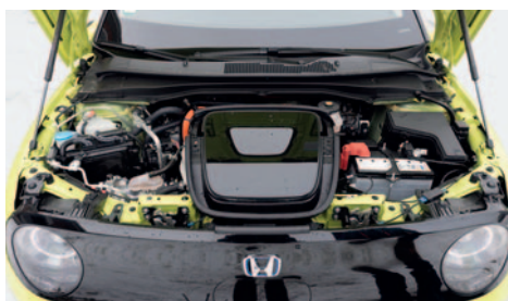
Blick unter die vordere Haube. In der Mitte ist die Ladeklappe.
