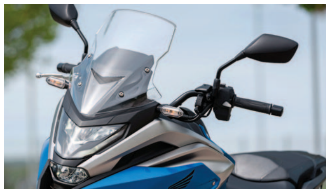
2021: Gut zu sehen: der nicht vorhandene Kupplungshebel der DCT-Version. Neues LED-Licht mit etwas besserer Lichtausbeute und dezenterer Entenschmabel.
