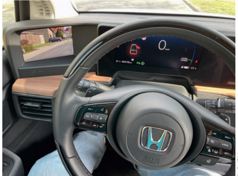
Toll gelöst: elektronische kamerabasierte „Außenspiegel“.
