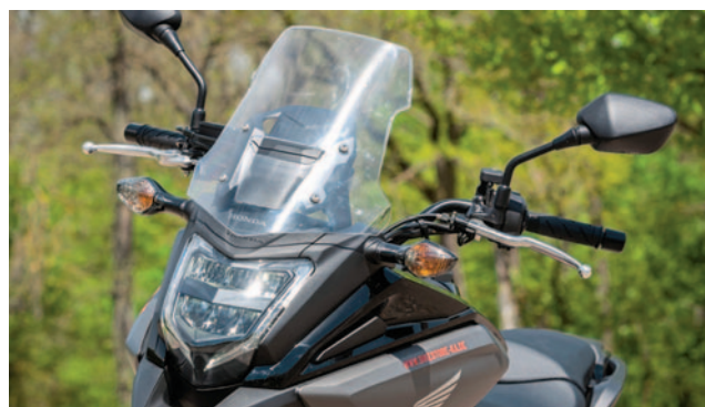
2020: Die Scheibe der Alten ist bei gleicher Höhe oben rund 40 Millimeter schmaler, was sich in einem Minus an Windschutz und einem Plus an Geräusch bemerkbar macht.
