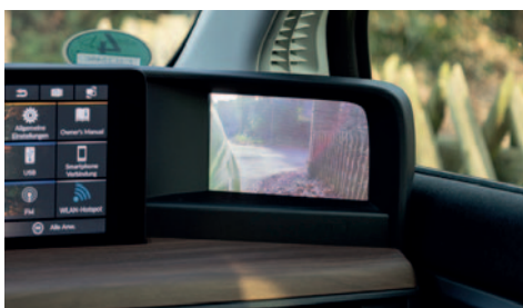
Kameras an beiden Seiten. Statt Spiegel hat der Honda Displays.
