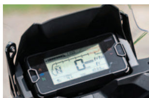
2021: Vom Lenker aus zu bedienendes LC-Display mit höherer Informationsdichte und -fülle, aber mäßiger Übersichtlichkeit.
