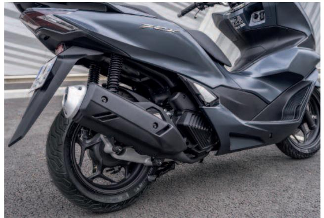
Der hintere Haltebügel ist jetzt schmaler ausgeführt. Diese Maßnahme spart sensationelle 310 g gegenüber dem vorherigen Design. Dazu bietet er dem Passagier während der Fahrt bequemen und sicheren Halt.
