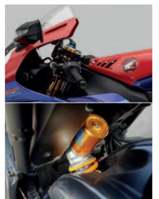
Die noch edleren SP-Federelemente steuert Öhlins bei.
