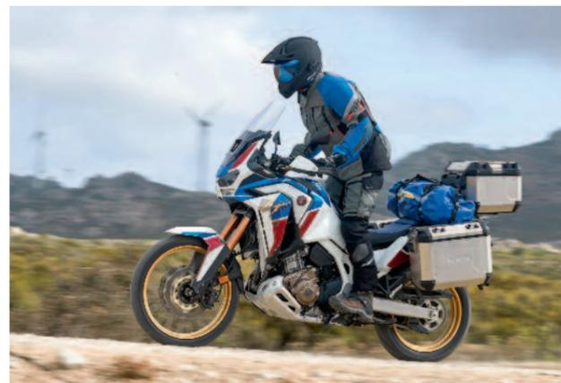
Modi und mit dem G-Switch eine traktionsoptimierte Offroad-Abstimmung anbietet. Zudem profitiert das Doppelkupplungsgetriebe von einer IMU-gestützten Kurven- und Steigungserkennung mit optimierten Schaltzeitpunkten, die in Schräglage und an Hängen ungünstige Gangwechsel vermeidet.
