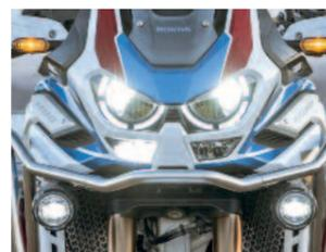
**DCT, LED:** Doppelkupplungsgetriebe hat nur Honda. Neuerdings gefüttert durch Schräglagensensorik. Neuer Scheinwerfer, darunter dreistufiges Kurvenlicht.
