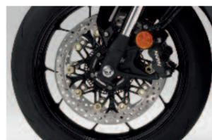
330 mm große Doppelscheibenbremsanlage am Vorderrad.
