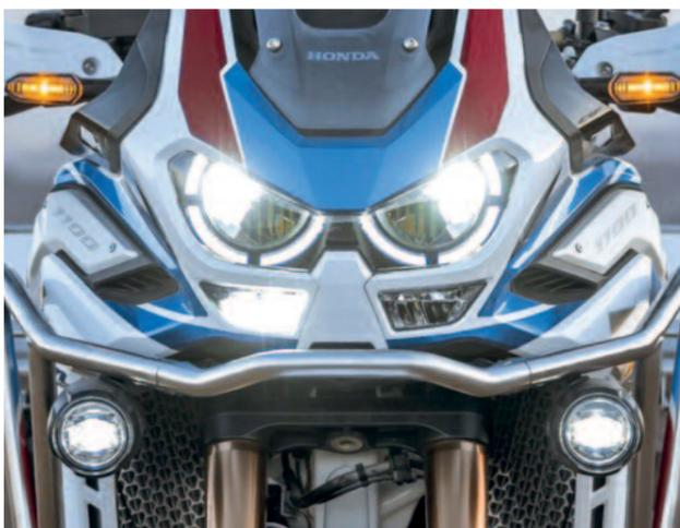
**Lichtgestalt:** LED-Doppelleuchte plus Tagfahr-, Kurven- und Positionslampen.
