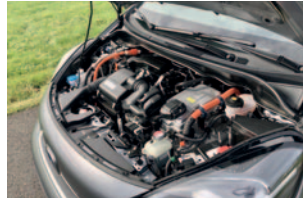
Der Benzinmotor mit 98 PS produziert meist Energie für einen Generator.
