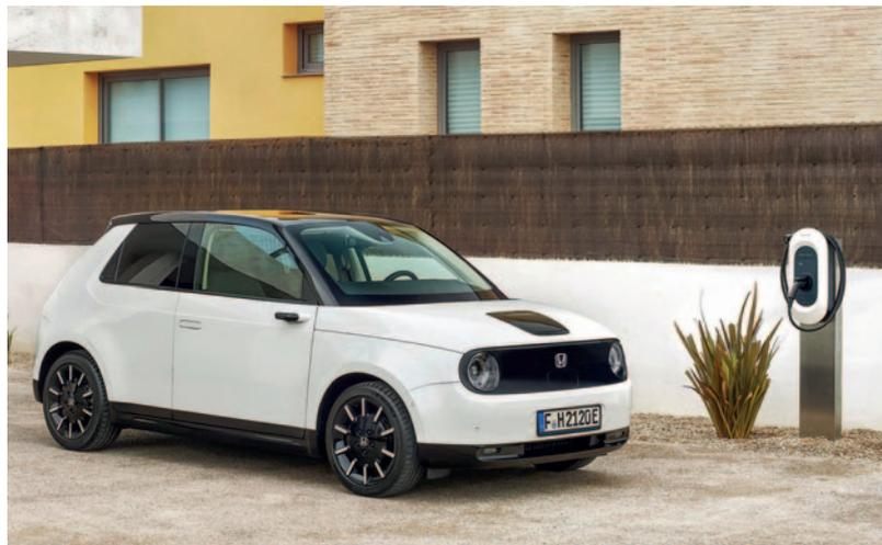
einheit aus dem Hause Hitachi sitzt. In der Advance-Version entwickelt der Motor 113 kW – also 154 PS – und drückt konstant mit 315 Nm Drehmoment auf die Hinterräder. Laut Honda beschleunigt das Topmodell so in durchaus glaubhaften 8,3 Sekunden von null auf 100 km/h, ist als 0,7 Sekunden schneller als die Basisversion mit 100 kW (136 PS). Vor allem im Sportmodus reagiert der kleine spontan auf Gasbefehle.
