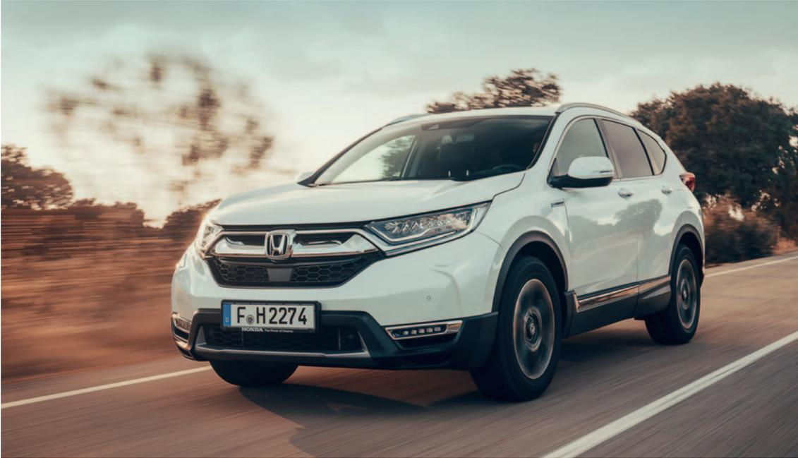
Das Hybrid-Modell Honda CR-V funktioniert ohne Steckdose. Der Benzinmotor speist einen Generator mit Energie, die der elektrische Antriebsmotor umsetzt.
