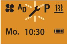
Wird im Display „Batterie schwach“ angezeigt, eine von Eberspächer empfohlene handelsübliche Knopfzelle des Typs **CR2430** der Hersteller Varta, Sony oder Renata besorgen und in das Mobilteil einsetzen.
