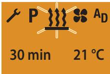
Anzeige bei Luftheizgeräten im Dauerheizbetrieb (Werkseinstellung).
