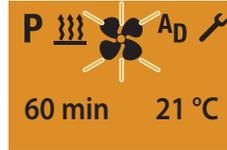
Anzeige bei Luftheizgeräten im Dauerbetrieb LÜFTEN.
