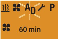
Anzeige bei Luftheizgeräten im Dauerbetrieb LÜFTEN (Werkseinstellung).
