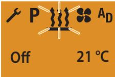
10 Sekunden nach der Anzeige HEIZEN OFF erlischt die Beleuchtung des Displays.
