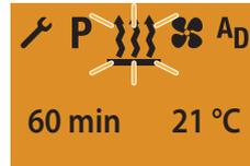
Anzeige bei Luftheizgeräten im Dauerheizbetrieb (Werkseinstellung).
