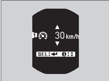
1. Drücken Sie die ▲(i)/▼-Taste, bis das Menü des Geschwindigkeitsalarms auf dem Display angezeigt wird, und drücken Sie dann die **SEL/RESET**-Taste.
