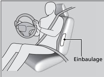
Die Seitenairbags sind im äußeren Bereich der Sitzlehne des Fahrer- und Beifahrersitzes angeordnet.
