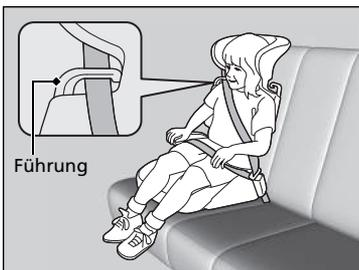
Für bestimmte Sitzunterlagen sind Rückenlehnen erhältlich. Installieren Sie die Rückenlehne an der Sitzunterlage und passen Sie diese gemäß der Anleitung des Sitzunterlagenherstellers an den Fahrzeugsitz an. Stellen Sie sicher, dass der Sicherheitsgurt ordnungsgemäß durch die Führung an der Rückenlehne verläuft und der Gurt den Nacken des Kindes weder berührt noch über ihn verläuft.
