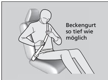
3. Führen Sie den Beckengurt möglichst tief über das Becken und ziehen Sie anschließend im Schulterbereich am Sicherheitsgurt, damit der Beckengurt eng anliegt. Dies bewirkt, dass Ihre kräftigen Beckenknochen die Aufprallkräfte absorbieren und die Gefahr innerer Verletzungen sinkt.
