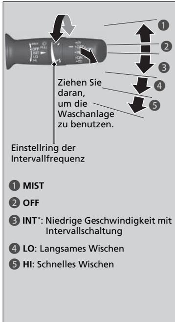
Wis- und Waschanlage der Windschutzscheibe können in der Schalterposition ZÜNDUNG EIN \*1 der Zündung verwendet werden.
