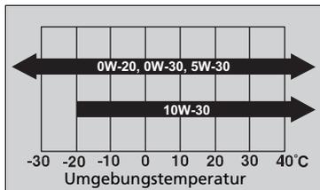
Verwenden Sie ein Original-Honda-Motoröl oder ein anderes kommerziell erhältliches Motoröl mit geeigneter SAE-Viskosität wie gezeigt für die jeweilige Umgebungstemperatur.
