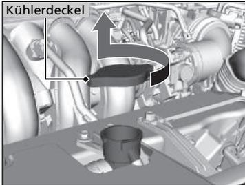
1. Stellen Sie sicher, dass Motor und Kühler abgekühlt sind.
