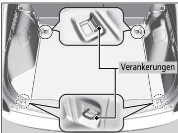
An den Verzurrösen am Gepäckraumboden kann ein Netz zur Ladungssicherung befestigt werden.
