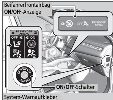
Steht der **ON/OFF**-Schalter für den Beifahrerfrontairbag auf:
