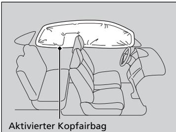
Der Kopfairbag ist so konzipiert, dass er bei einem mittelschweren bis schweren Seitenaufprall ausgelöst wird.
