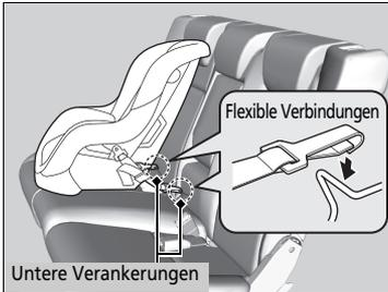
4. Stellen Sie das Kinderrückhaltesystem auf den Fahrzeugsitz und befestigen Sie dann das Kinderrückhaltesystem entsprechend der Herstelleranweisungen an den unteren Verankerungen.
