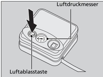
7. Den Luftkompressorschalter einschalten, um den Reifen aufzupumpen.
