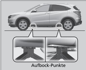
1. Stellen Sie den Wagenheber unter den Hebebock, der dem zu wechselnden Reifen am nächsten liegt.
