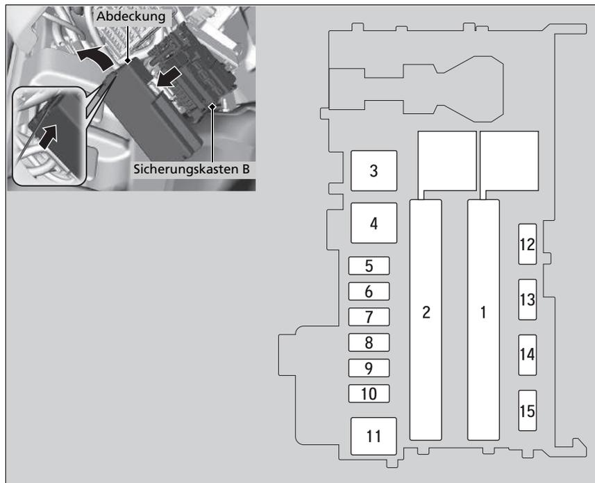
■ **Geschützte Schaltungen und Sicherungsnennstrom**
