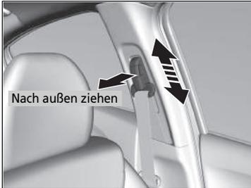
1. Ziehen Sie die Entriegelung nach außen und bewegen Sie gleichzeitig die Sicherheitsgurtverankerung nach oben oder unten.
