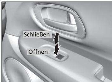
**Öffnen:** Drücken Sie den Schalter leicht nach unten, bis die gewünschte Position erreicht ist.
