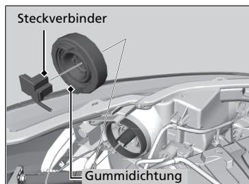
1. Entfernen Sie den Steckverbinder.
