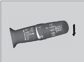
Wenn Sie den Hebel nach unten in die Stellung **AUTO** drücken, werden die Scheibenwischer einmal betätigt und schalten in den Automatikmodus.
