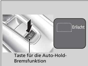
Drücken Sie bei eingeschaltetem System nochmals die Taste für die Auto-Hold-Bremsfunktion.
