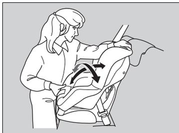
**5.** Drücken Sie die Lasche nach unten. Führen Sie den Schultergurt des Sicherheitsgurtes in den Schlitz an der Seite des Rückhaltesystems.
