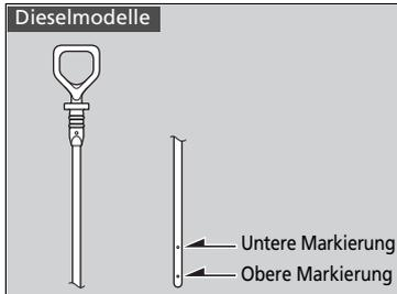
4. Den Ölmess-Stab wieder herausziehen und den Füllstand ablesen. Der Füllstand muss zwischen der oberen und unteren Markierung liegen. Füllen Sie bei Bedarf Öl nach.
