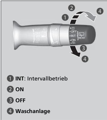
Heckscheibenwischer und Waschanlage können verwendet werden, wenn sich der Zündschalter in der Stellung ZÜNDUNG EIN **II**\*<sup>1</sup> befindet.
