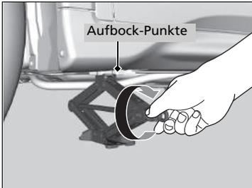
2. Drehen Sie die Aufnahme am Ende im Uhrzeigersinn (wie in der Abbildung gezeigt), bis der Wagenheber oben am Hebebock anliegt.
