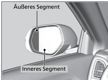
Der fahrerseitige Außenspiegel verfügt über äußere und innere Segmente.
