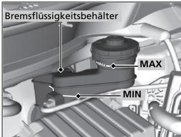
Der Flüssigkeitsstand muss zwischen der **MIN**- und der **MAX**-Markierung an der Seite des Behälters liegen.
