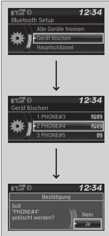
■ **Löschen Sie ein zuvor gekoppeltes Mobiltelefon.**
