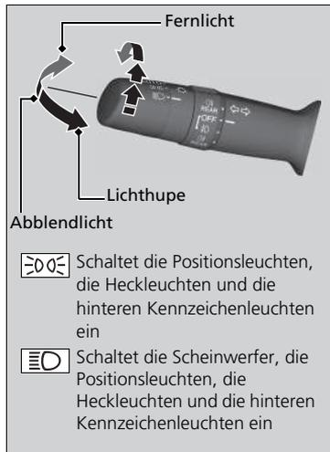
Beim Drehen des Lichtschalters wird die Beleuchtung, unabhängig von der Zündschalterstellung, ein- und ausgeschaltet\*1.
