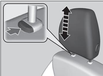
**Anheben der Kopfstütze:** Ziehen Sie sie nach oben.
