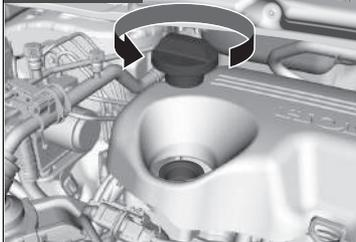
1. Schrauben Sie den Motoröl-Einfülldeckel ab.
