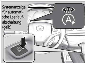
Drücken Sie diese Taste zum Ausschalten der automatischen Leerlaufabschaltung. Die automatische Leerlaufabschaltung wird deaktiviert.
