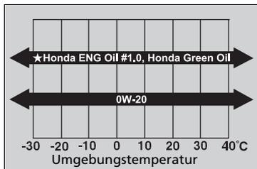
Verwenden Sie ein handelsübliches Motoröl mit der passenden Viskosität für die aufgeführte Umgebungstemperatur.
