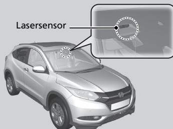
Der Lasersensor befindet sich hinter dem Rückspiegel.
