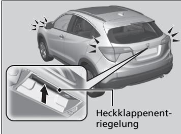
Die Heckklappenentriegelungstaste drücken:
