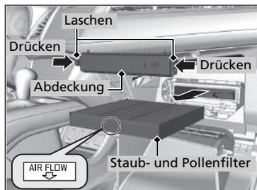
5. Drücken Sie in die Laschen an den Ecken der Filtergehäuseabdeckung, und entfernen Sie diese.
