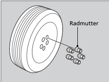
1. Schrauben Sie die Radmutter ab, und bauen Sie den platten Reifen ab.
