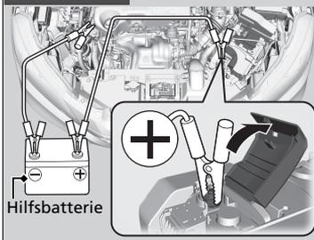
1. Das erste Überbrückungskabel an den  $\oplus$ -Pol Ihres Fahrzeugs anschließen.
