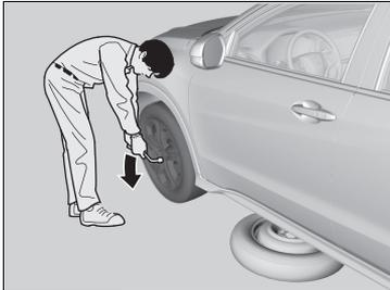
**7.** Lösen Sie jede Radmutter mit dem Radmutternschlüssel ca. eine Umdrehung.
