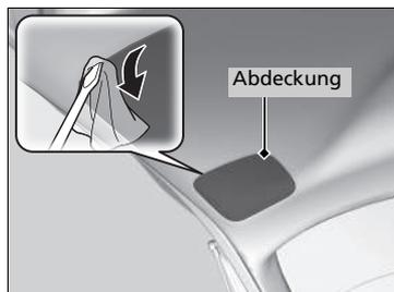
1. Entfernen Sie die Abdeckung durch Anheben der Kante mit einem Schlitzsraubendreher.
