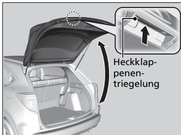
Wenn alle Türen entriegelt sind, ist auch die Heckklappe entriegelt. Drücken Sie auf die Heckklappenentriegelung, und heben Sie die Heckklappe an, um diese zu öffnen.
