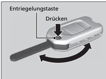
Der Schlüssel kann in die Fernbedienung eingeklappt werden.
