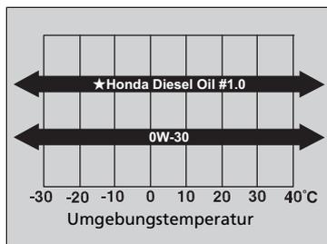
Verwenden Sie ein handelsübliches Motoröl mit der passenden Viskosität für die aufgeführte Umgebungstemperatur.
