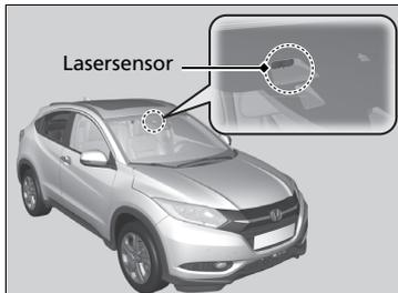
Die City-Notbremsassistent-Einheit mit dem Lasersensor befindet sich hinter dem Rückspiegel.
