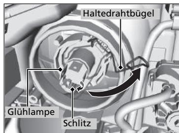
3. Entfernen Sie den Haltedrahtbügel und nehmen Sie anschließend die Glühlampe heraus.
