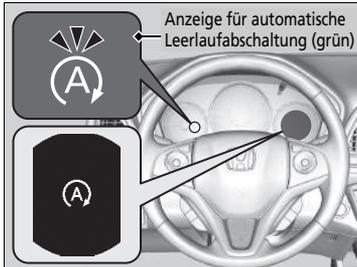
Sobald das Kupplungspedal betätigt wird und das Fahrzeug sich erneut in Bewegung setzen soll, wird der Motor wieder gestartet und die Anzeige (grün) erlischt.
