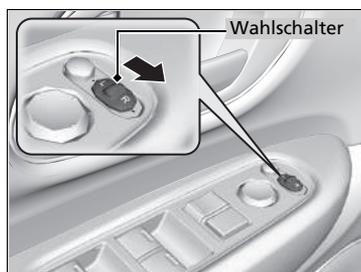
Bei aktiviertem System kippt der beifahrerseitige Außenspiegel automatisch nach unten, wenn Sie den Schalthebel auf **R** stellen. Dies verbessert beim Rückwärtsfahren die Sicht im Nahbereich auf der Beifahrerseite des Fahrzeugs. Wenn Sie den Schalthebel auf eine andere Stellung als **R** stellen, wird der Spiegel wieder in seine ursprüngliche Position bewegt.
