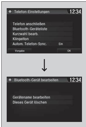
■ **So bearbeiten Sie den Namen eines bereits gekoppelten Telefons**
