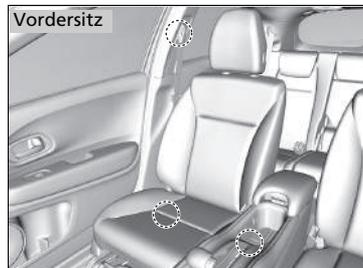
Verwenden Sie bei einem Austausch der Sicherheitsgurte die in den Abbildungen gezeigten Verankerungspunkte.
