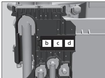
Ziehen Sie die Schutzabdeckung von der ⊕-Klemme hoch und entfernen Sie diese, während Sie die Lasche wie abgebildet herausziehen.
