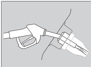
4. Führen Sie den Kraftstoff-Einfüllstutzen vollständig ein.
