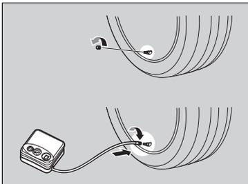
4. Prüfen Sie erneut den Reifendruck mit dem Messgerät am Luftkompressor.
