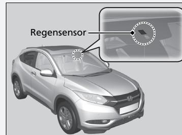
Bringen Sie den Scheibenwischerhebel bei der Reinigung der Windschutzscheibe oder beim Durchfahren einer Waschstraße nicht in Stellung **AUTO**. Wenn der Scheibenwischerhebel in der Stellung **AUTO** und der Zündschalter in der Position ZÜNDUNG EIN **II** \*<sup>1</sup> ist, kann der Regensensor auf Ihre Hand oder Flüssigkeiten der Waschanlage reagieren und die Scheibenwischer automatisch in Betrieb nehmen.
