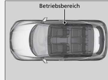
Sie können den Motor starten, wenn sich die schlüssellose Fernbedienung im Inneren des Fahrzeugs befindet. Der Motor kann auch laufen, wenn sich die schlüssellose Fernbedienung in der Nähe einer Tür oder eines Fensters befindet (auch außerhalb des Fahrzeugs).
