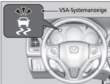
Bei aktivierter VSA kann es vorkommen, dass der Motor nicht auf das Gaspedal reagiert. Es können auch Geräusche aus der Hydraulikanlage hörbar sein. Außerdem blinkt die Anzeige.
