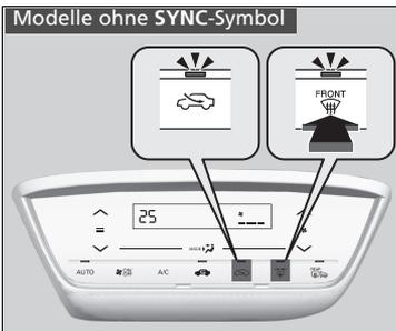
Mit dem -Symbol wird die Klimaanlage eingeschaltet und das System schaltet automatisch in den Frischluftmodus um.
