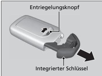
Der integrierte Schlüssel kann zum Verriegeln der Türen verwendet werden, wenn die Batterie der schlüsselloosen Fernbedienung leer und das Ver-/Entriegeln über die Zentralverriegelung nicht mehr möglich ist.
