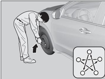
5. Senken Sie das Fahrzeug ab, und entfernen Sie den Wagenheber. Ziehen Sie die Radmutter in der gezeigten Reihenfolge fest. Ziehen Sie die Muttern zwei oder drei Mal in dieser Reihenfolge der Reihe nach fest.
