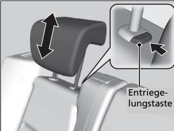
Ein Fahrgast auf dem mittleren oder auf einem äußeren Rücksitz sollte die Höhe seiner Kopfstütze vor Fahrtantritt auf eine geeignete Position einstellen.
