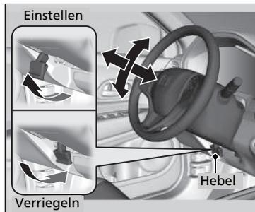
1. Ziehen Sie den Lenkradverstellhebel nach oben.
