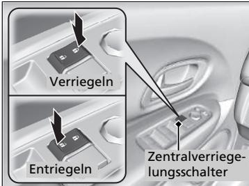
Drücken Sie den Zentralverriegelungsschalter wie gezeigt, um alle Türen und die Heckklappe zu ver- bzw. entriegeln.
