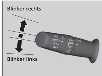
Die Blinker können bei Position ZÜNDUNG EIN
