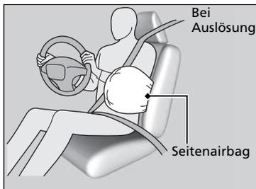
Wenn die Sensoren einen mittelschweren bis schweren Seitenaufprall erfassen, löst die Steuereinheit den Seitenairbag auf der Aufprallseite sofort aus.
