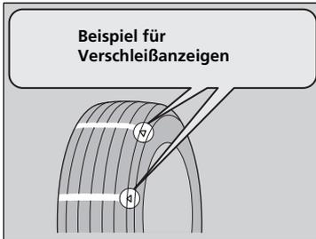
Die Nut ist an der Position der Verschleißanzeige 1,6 mm flacher als am Rest des Reifens. Wechseln Sie den Reifen, wenn das Profil so weit verschlissen ist, dass der Verschleißindikator sichtbar wird.
