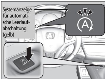
Zum Ausschalten der automatischen Leerlaufabschaltung drücken Sie diese Taste. Die automatische Leerlaufabschaltung wird deaktiviert.
