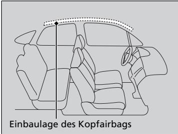
Die Kopfairbags befinden sich auf beiden Fahrzeugseiten im Dachhimmel über den Seitenscheiben.
