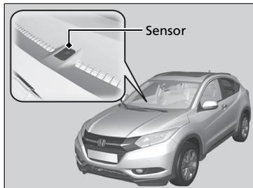
Die Klimaautomatik ist mit Sensoren ausgestattet. Achten Sie darauf, dass diese Sensoren nicht verdeckt oder mit Flüssigkeit benetzt werden.
