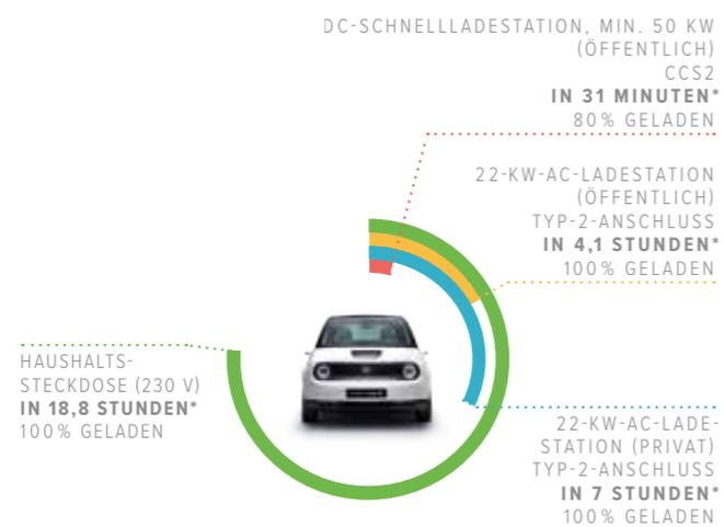
\* Berechnet ab Aufleuchten der Ladeaufforderung in der Instrumententafel. Die tatsächliche Ladezeit hängt von verschiedenen Einflussfaktoren ab, darunter die Umgebungstemperatur, die Batterietemperatur, die Entladetiefe der Batterie und die Verwendung von elektrischen Zusatzgeräten, wie z. B. für die Heizung des Fahrgastraums während des Ladevorgangs. Dadurch kann die Ladezeit deutlich vom hier berechneten Wert abweichen.
