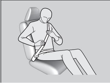
3. Führen Sie den Beckengurt möglichst tief über das Becken (siehe Abbildung) und ziehen Sie anschließend im Schulterbereich am Sicherheitsgurt, damit der Beckengurt eng anliegt. Dies bewirkt, dass Ihre kräftigen Beckenknochen die Aufprallkräfte absorbieren und die Gefahr innerer Verletzungen sinkt.
