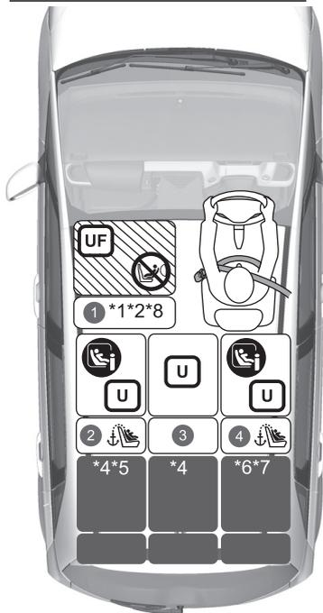
Beifahrer-Airbag ausgeschaltet für Rechtslenker-Ausführung
