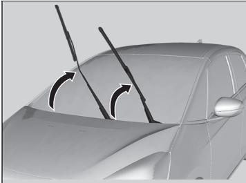
1. Heben Sie zunächst den Scheibenwischerarm auf der Fahrerseite ab, dann den auf der Beifahrerseite.
