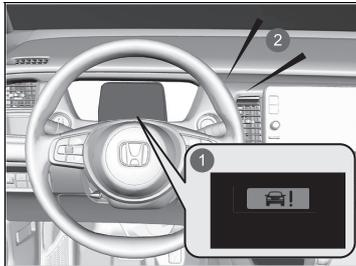
Das System gibt bei einer Kollisionsgefahr akustische und optische Warnsignale aus; sobald keine Kollisionsgefahr mehr besteht, wird der Alarm aufgehoben.
