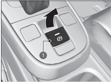
① Schalter für die elektrische Feststellbremse
