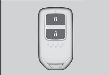
Nutzen Sie die Schlüssel zum Ein- und Ausschalten des Stromversorgungssystems sowie zum Ver- und Entriegeln aller Türen, der Heckklappe und der Tankklappe.
