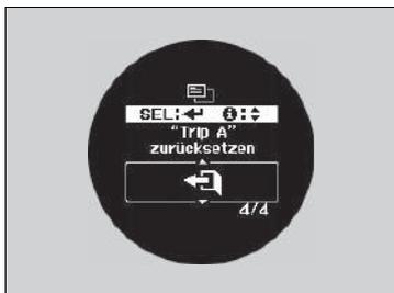
4. Drücken Sie die /▼-Taste, bis auf dem Display „**Trip A**“ Zeit zurücksetzen angezeigt wird. Drücken Sie danach die **SEL/RESET**-Taste.
