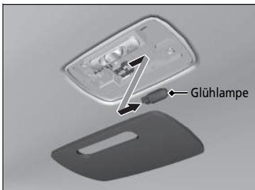
2. Entfernen Sie die alte Glühlampe, und setzen Sie eine neue ein.
