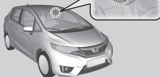
Das System wird automatisch aktiviert, wenn der Geschwindigkeitsunterschied zwischen Ihrem und dem vorausfahrenden Fahrzeug zwischen 5 km/h und 32 km/h beträgt und dabei eine hohe Kollisionsgefahr besteht.
