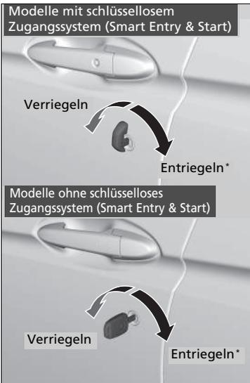
Stecken Sie den Schlüssel vollständig ein und drehen Sie ihn.
