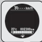
Die Anzeige befindet sich im oberen Bereich des Multi-Informationdisplays. Der Tempomat ist einsatzbereit.
