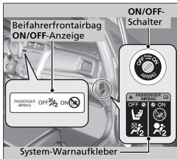
Steht der **ON/OFF**-Schalter für den Beifahrerfrontairbag auf:
