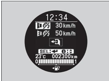
1. Drücken Sie die ▲(i)/▼-Taste, bis die Einstellung des Geschwindigkeitsalarms auf dem Display angezeigt wird, und drücken Sie dann die **SEL/RESET**-Taste.
