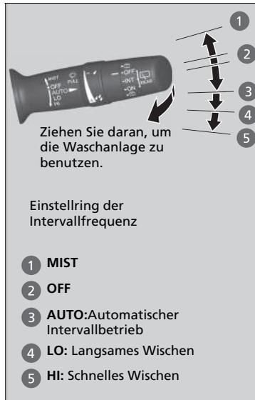
Wis- und Waschanlage der Windschutzscheibe können in der Schalterposition ZÜNDUNG EIN  \*1 der Zündung verwendet werden.
