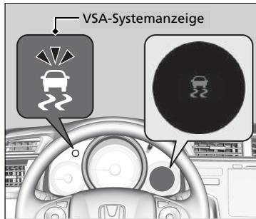
Bei aktivierter VSA kann es vorkommen, dass der Motor nicht auf das Gaspedal reagiert. Es können auch Geräusche aus der Hydraulikanlage hörbar sein. Außerdem blinkt die Anzeige.
