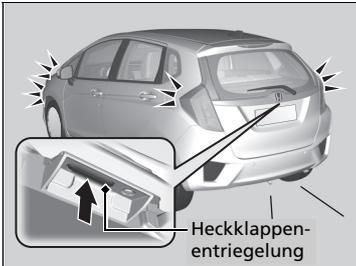
Die Heckklappenentriegelungstaste drücken:
