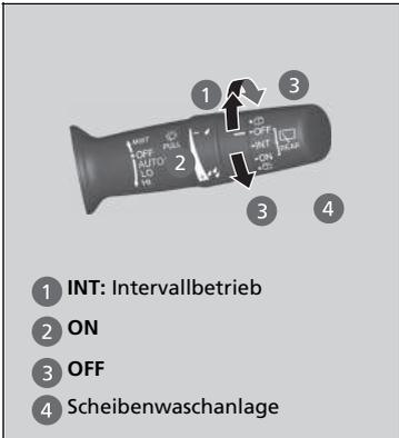
Heckscheibenwischer und Waschanlage können verwendet werden, wenn sich der Zündschalter in der Stellung ZÜNDUNG EIN **II**\*1 befindet.
