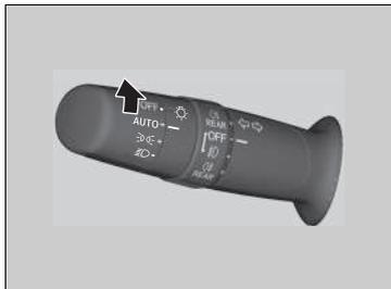
Die automatische Beleuchtungssteuerung kann in der Zündschalterposition ZÜNDUNG EIN verwendet werden **II**\*1.
