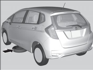
6. Legen Sie das Kompaktreserverad (mit der Radseite nach oben) in der Nähe des zu wechselnden Rads unter der Fahrzeuggarosserie ab.
