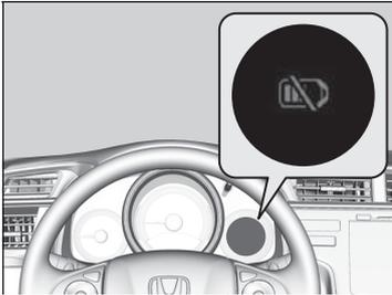
Innerhalb und/oder außerhalb des Fahrzeugs können Warntöne erklingen, mit denen Sie darauf hingewiesen werden, dass sich die schlüssellose Fernbedienung außerhalb des Fahrzeugs befindet. Sollte der Warnton auch noch ertönen, wenn sich die Fernbedienung wieder im Fahrzeug befindet, sorgen Sie dafür, dass sie sich auch im Funktionsbereich befindet.
