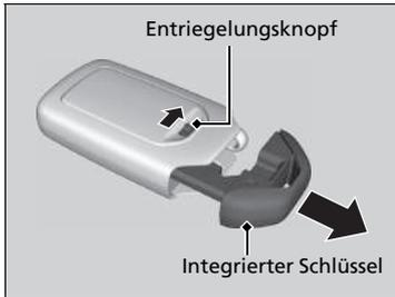
Der integrierte Schlüssel kann zum Ver-/Entriegeln der Türen verwendet werden, wenn die Batterie der schlüssellosen Fernbedienung leer und das Ver-/Entriegeln über die Zentralverriegelung nicht mehr möglich ist.
