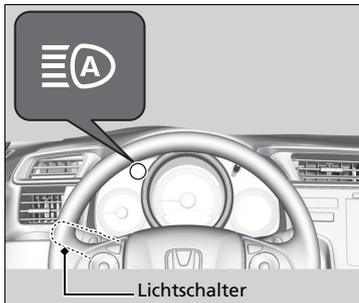
Schalten Sie zum Aktivieren des Systems den Lichtschalter auf **AUTO** und die Scheinwerfer auf **Ablblendetlicht**. Die Anzeige des Fernlichtassistenten wird eingeschaltet.
