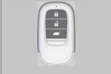
Die Schlüssel dienen zum Starten und Stoppen des Motors sowie zum Ver- und Entriegeln der Türen, der Heckklappe und der Tankklappe.
