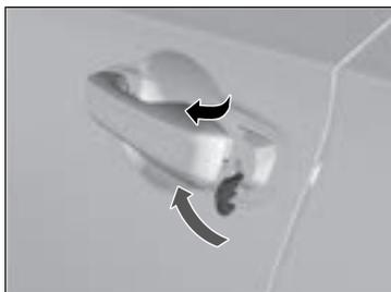
Führen Sie den Schlüssel von der Unterseite des Griffs aus in den Schließzylinder ein und drehen Sie ihn.
