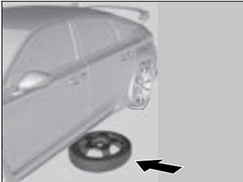
5. Legen Sie einen Unterlegkeil oder Stein vor und hinter das Rad, das dem zu wechselnden Rad diagonal gegenüberliegt.
