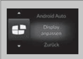
1. Drehen Sie das linke Auswahrad, bis **Display anpassen** auf dem Display angezeigt wird. Drücken Sie dann auf das linke Auswahrad.
