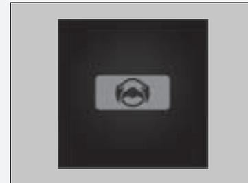
Wenn der Fahrer das Lenkrad nicht bedient, nachdem die oben gezeigte Warnung wiederholt angezeigt wurde, ertönt ein Warnsummer und der Stauassistent zur Spurhaltung TJA (Traffic Jam Assist) wird deaktiviert.
