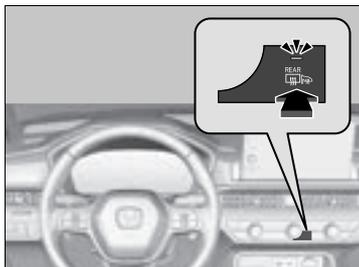
Drücken Sie die Taste für die Heckscheibenheizung und die beheizbaren Außenspiegel, wenn der Betriebsmodus EIN ist, um Beschlag von der Heckscheibe und den Außenspiegeln zu entfernen.
