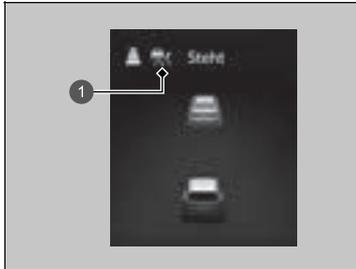
Ihr Fahrzeug hält automatisch an. Die Meldung **Steh** wird auf dem Instrument angezeigt. Wenn das Fahrzeug vor Ihnen wieder anfährt und Sie den **RES/+ / SET/--**-Schalter nach oben oder unten drücken oder das Gaspedal betätigen, wird die ACC mit Stauassistent zur Geschwindigkeitsregelung LSF (Low Speed Follow) wieder mit der zuvor eingestellten Geschwindigkeit aktiviert.
