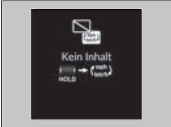
Ermöglicht die Anzeige einer anderen Einheit auf dem Fahrer-Informationsdisplay, dem Head-Up-Display und dem Audio-/Informationsbildschirm sowie die Einstellung der angezeigten Werte auf km und km/h oder Meilen und mph.
