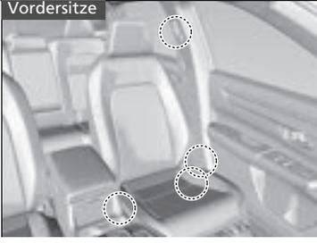
Verwenden Sie bei einem Austausch der Sicherheitsgurte die in den Abbildungen gezeigten Verankerungspunkte.
