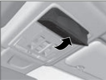
Drücken Sie am Deckel auf die Vertiefung, um den Brillenhalter zu öffnen. Um den Brillenhalter zu schließen, drücken Sie erneut auf die Vertiefung, bis der Deckel einrastet.
