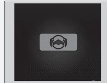
Wenn der Fahrer das Lenkrad nicht ergreift, nachdem die oben gezeigte Warnung wiederholt angezeigt wurde, ertönt ein Warnsummer, und der Stauassistent zur Spurhaltung wird deaktiviert.
