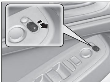
Bei aktiviertem System kippt der beifahrerseitige Außenspiegel automatisch nach unten, wenn Sie den Schalthebel in die Stellung **R** bringen: Dadurch verbessert sich die Sicht im Nahbereich auf der Beifahrerseite beim Einparken. Wenn Sie den Schalthebel in eine andere Stellung als **R** bringen, wird der Spiegel automatisch in seine ursprüngliche Position zurückbewegt.
