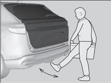
Führen Sie unter der Mitte der Heckstoßstange ca. 1 Sekunde lang eine vorwärts und rückwärts gerichtete Tretbewegung aus, um die elektrische Heckklappe zu öffnen oder zu schließen, während Sie die schlüssellose Fernbedienung bei sich tragen.
