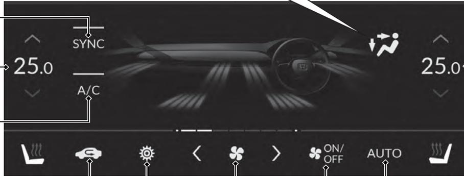
Schaltfläche für die Temperatureinstellung auf der Fahrerseite
