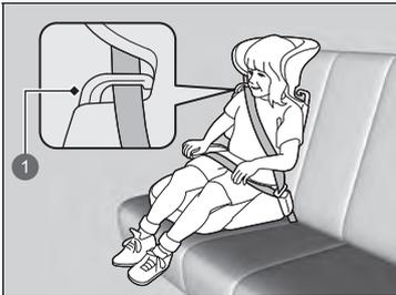
Für bestimmte Sitzunterlagen sind Rückenlehnen erhältlich. Installieren Sie die Rückenlehne an der Sitzunterlage und passen Sie diese gemäß Herstelleranleitung an den Fahrzeugsitz an. Stellen Sie sicher, dass der Sicherheitsgurt ordnungsgemäß durch die Führung an der Rückenlehne verläuft und der Gurt den Hals des Kindes weder berührt noch über ihn verläuft.
