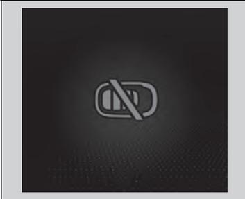
Wenn der Betriebsmodus auf einen anderen Modus als AUS gestellt ist und Sie die schlüssellose Fernbedienung aus dem Fahrzeug entfernen und die Tür schließen, ertönt ein Alarm. Wenn der Alarm weiterhin ertönt, bringen Sie die schlüssellose Fernbedienung an einen anderen Ort.
