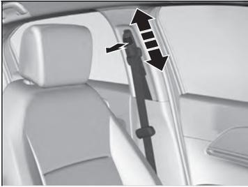
1. Bewegen Sie die Schultergurt-Verankerung nach oben und unten und ziehen Sie diese gleichzeitig nach außen.
