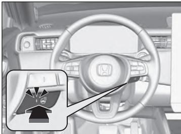
Bei Verwendung der Lenkradheizung muss der Betriebsmodus auf EIN gestellt sein.
