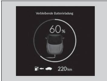
Zeigt den aktuellen Status der Hochspannungsbatterie an. Die Farbe des Kreises stellt den aktuellen Status der Hochspannungsbatterie dar.
