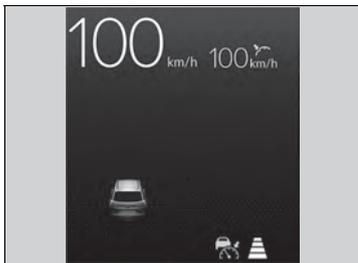
Ihr Fahrzeug hält die eingestellte Geschwindigkeit konstant, ohne dass Sie das Brems- oder Gaspedal betätigen müssen.
