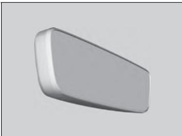
Wenn Sie bei Dunkelheit fahren, verringert der automatisch abblendende Rückspiegel anhand der Signale vom Spiegelsensor die Blendwirkung durch Scheinwerfer nachfolgender Fahrzeuge. Diese Funktion ist immer aktiv.
