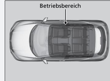
Sie können den Motor starten, wenn sich die schlüssellose Fernbedienung im Inneren des Fahrzeugs befindet. Der Motor kann auch laufen, wenn sich die schlüssellose Fernbedienung in der Nähe einer Tür oder eines Fenster befindet (auch außerhalb des Fahrzeugs).
