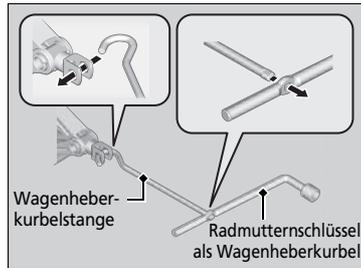
3. Heben Sie das Fahrzeug mit der Wagenheberkurbelstange und der Wagenheberkurbel an, bis der Reifen vom Boden abhebt.
