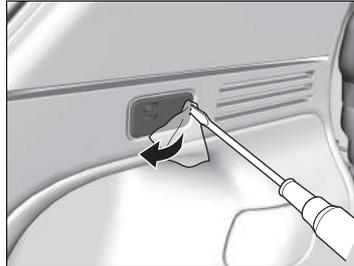
1. Heben Sie die Kante der Leuchte mit einem Schlitzschraubendreher an, um die Leuchtenbaugruppe zu entfernen.
