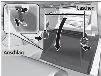
2. Drücken Sie den Anschlag auf der Beifahrerseite des Handschuhfachs, um ihn zu lösen.
