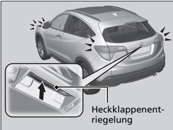
Die Heckklappenentriegelungstaste drücken:
