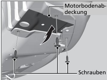
1. Entfernen Sie die Schrauben mit einem Kreuzschlitzschraubendreher und drücken Sie die untere Abdeckung nach oben.
