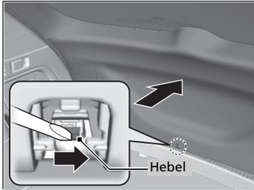
3. Um die Heckklappe zu öffnen, schieben Sie den Hebel nach rechts und drücken gleichzeitig gegen die Heckklappe.
