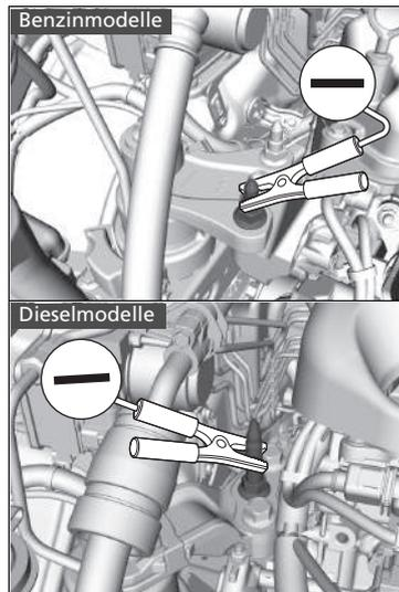
4. Schließen Sie das andere Ende des zweiten Überbrückungskabels wie abgebildet am Stehbolzen an. Schließen Sie dieses Überbrückungskabel an keiner anderen Stelle an.
