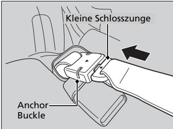
2. Richten Sie die Dreiecksmarkierung auf der kleinen Schlosszunge an der Markierung auf dem Anchor Buckle aus. Stellen Sie sicher, dass der Sicherheitsgurt nicht verdreht ist. Befestigen Sie den Sicherheitsgurt am Anchor Buckle.
