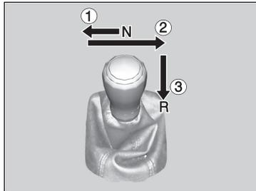
1. Drücken Sie das Kupplungspedal durch, bewegen Sie den Schalthebel vollständig nach links und schalten Sie in die Position **R**.
