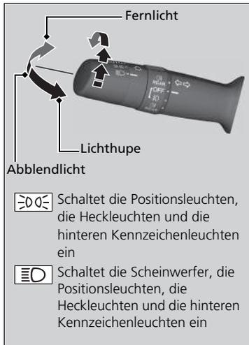
Beim Drehen des Lichtschalters wird die Beleuchtung, unabhängig von der Zündschalterstellung, ein- und ausgeschaltet\*<sup>1</sup>.
