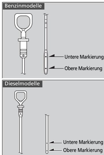
4. Den Ölmess-Stab wieder herausziehen und den Füllstand ablesen. Der Füllstand muss zwischen der oberen und unteren Markierung liegen. Füllen Sie bei Bedarf Öl nach.
