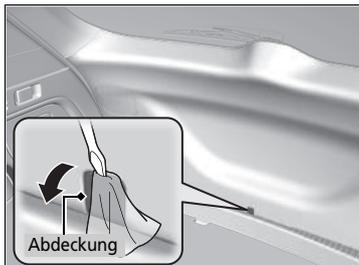
1. Wickeln Sie ein Tuch um die Spitze eines kleinen Schlitzschraubendrehers. Stecken Sie ihn, wie in der Abbildung dargestellt, zum Öffnen der Abdeckung hinein.
