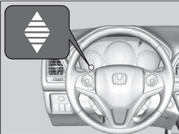
Diese Anzeigen leuchten auf, um Ihnen beim manuellen 7-Gang-Schaltmodus eine Schaltempfehlung zu geben, mit der Sie die beste Kraftstoffausnutzung erzielen.
