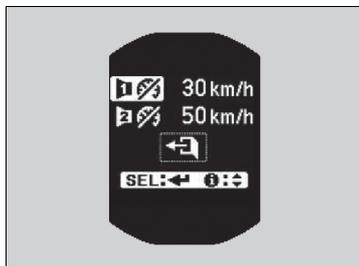
1. Drücken Sie die /▼-Taste, bis die Einstellung des Geschwindigkeitsalarms auf dem Display angezeigt wird, und drücken Sie dann die **SEL/RESET**-Taste.
