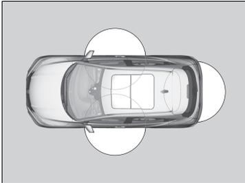
Wenn Sie die schlüssellose Fernbedienung bei sich tragen, können Sie die Türen und die Heckklappe ver-/entriegeln.
