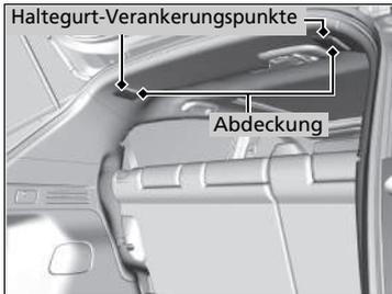
Am Dachhimmel befinden sich zwei Haltegurt-Verankerungspunkte für die äußeren Rücksitzplätze. Bei einem Kinderrückhaltesystem, das mit einem Dreipunktgurt installiert ist und über einen Haltegurt verfügt, bringt der Haltegurt zusätzliche Sicherheit.
