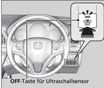
Zum Abschalten des Ultraschallsensorsystems drücken Sie die **OFF**-Taste des Ultraschallsensors, nachdem Sie den Schlüssel aus dem Zündschalter gezogen haben oder wenn der Schlüssel auf ZUBEHÖR **1** oder SPERRE **0** \*<sup>1</sup> gestellt ist.
