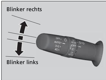
Die Blinker können bei Position ZÜNDUNG EIN
