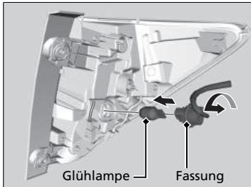
3. Drehen Sie die Fassung nach links und entfernen Sie sie. Entfernen Sie die alte Glühlampe.
