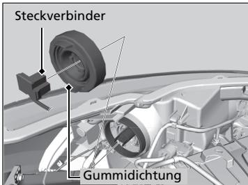
1. Entfernen Sie den Steckverbinder.
