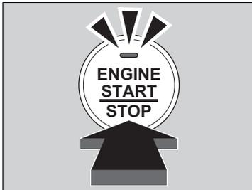
2. Betätigen Sie innerhalb von 10 Sekunden nach Ertönen des Beepers und Dauerleuchten der Anzeige das Bremspedal (stufenloses Automatikgetriebe) bzw. das Kupplungspedal (Schaltgetriebe) und drücken Sie die **ENGINE START/STOP**-Taste.
