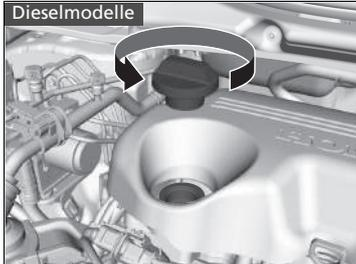
1. Schrauben Sie den Motoröl-Einfülldeckel ab.
