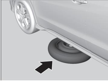
6. Legen Sie das Reserverad (mit der Rad-Seite nach oben) in der Nähe des zu wechselnden Rads unter das Fahrzeug.
