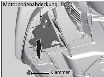
1. Entfernen Sie die Klammer mit einem Schlitzschraubendreher und drücken Sie die untere Abdeckung nach oben.
