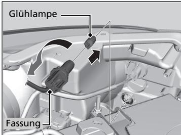
1. Drehen Sie die Fassung nach links, und bauen Sie sie aus. Bauen Sie anschließend die alte Glühlampe aus.
