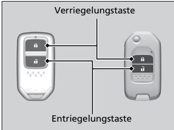
**Öffnen:** Drücken Sie die Entriegelungstaste innerhalb von 10 Sekunden zweimal und halten Sie diese beim zweiten Mal gedrückt.
