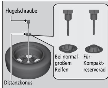
2. Nehmen Sie den Distanzkonus von der Flügelschraube ab, drehen Sie ihn um und setzen Sie ihn wieder auf die Schraube auf.
