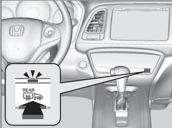
Je nach Außentemperatur werden Heckscheibenheizung und die beheizbaren Außenspiegel automatisch nach 10-30 Minuten ausgeschaltet.
