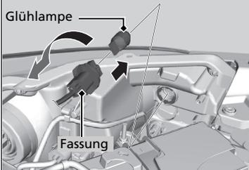
1. Drehen Sie die Fassung nach links und entfernen Sie sie.
