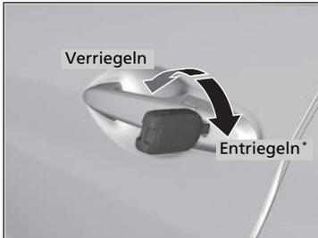
Stecken Sie den Schlüssel vollständig ein und drehen Sie ihn.
