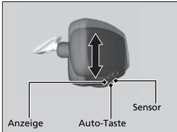
Der automatisch abblendende Rückspiegel verringert die Blendung durch Scheinwerfer nachfolgender Fahrzeuge bei Nachtfahrten. Die Auto-Taste drücken, um diese Funktion ein- und auszuschalten. Bei eingeschalteter Funktion leuchtet die AUTO-Anzeige auf.
