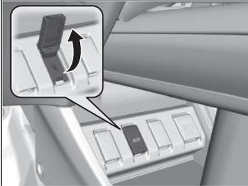
Verwenden Sie zum Anschließen von Standard-Audiogeräten den AUX-Eingang.
