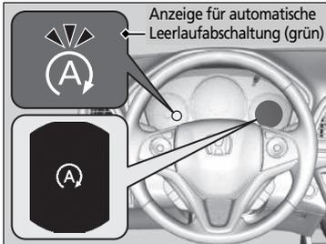
Wenn sich das Fahrzeug erneut in Bewegung setzen soll, wird der Motor wieder gestartet und die Anzeige (grün) erlischt. Auf dem Multi-Informationsdisplay wird eine Meldung zur automatischen Leerlaufabschaltung angezeigt.
