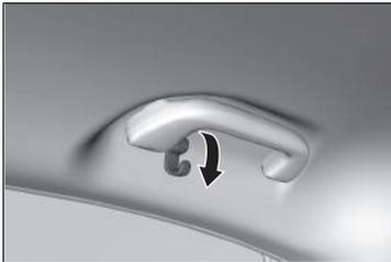
Die Kleiderhaken befinden sich an den Haltegriffen links und rechts. Ziehen Sie sie herunter, um sie zu verwenden.
