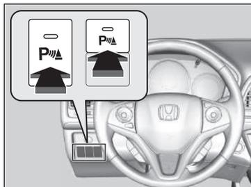
Zum Ein- und Ausschalten des Systems drücken Sie auf die Taste Einparkhilfe, wenn der Zündschalter auf ZÜNDUNG EIN **II**\*<sup>1</sup> steht. Wenn das System eingeschaltet ist, leuchtet die Anzeige in der Taste.
