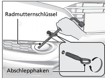
3. Entnehmen Sie den Abschlepphaken und den Radmutterenschlüssel aus dem Gepäckraum.
