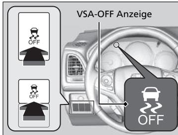
Diese Taste befindet sich auf dem Bedienfeld an der Fahrerseite. Um Teilfunktionen des VSA-Systems ein- und auszuschalten, halten Sie diese Taste gedrückt, bis ein akustisches Signal ertönt.
