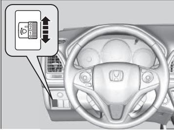
Der Vertikalwinkel der Abblendlicht-Scheinwerfer kann eingestellt werden, wenn sich der Zündschalter in der Stellung EIN **II**\*<sup>1</sup> befindet.
