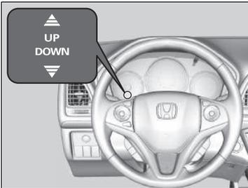
Diese Anzeigen leuchten auf, um anzuzeigen, dass ein Gangwechsel angemessen ist, um die Fahrweise mit der besten Kraftstoffausnutzung zu erhalten.
