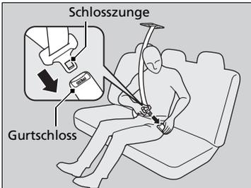
3. Stecken Sie die Schlosszunge in das Gurtschloss. Legen Sie den Sicherheitsgurt wie einen üblichen Dreipunktgurt korrekt an.
