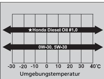
Verwenden Sie ein handelsübliches Motoröl mit der passenden Viskosität für die aufgeführte Umgebungstemperatur.
