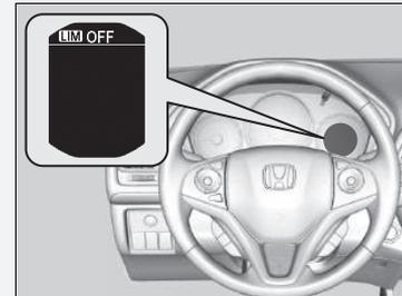
Falls ein Problem mit dem System vorliegt, wenn Sie den Geschwindigkeitsbegrenzer verwenden, ertönt der Warnton und leuchtet **OFF** auf. Der Geschwindigkeitsbegrenzer wird ausgeschaltet.
