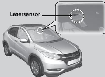
Der Lasersensor befindet sich hinter dem Rückspiegel.
