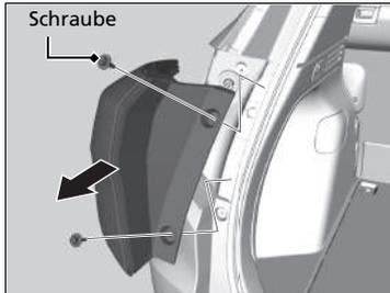
1. Entfernen Sie die Schrauben mit einem Kreuzschlitzschraubendreher.
