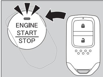
1. Berühren Sie bei blinkender Anzeige auf der **ENGINE START/STOP**-Taste die Mitte der **ENGINE START/STOP**-Taste mit dem **H**-Logo auf der schlüssellosen Fernbedienung. Die Tasten auf der schlüssellosen Fernbedienung müssen zu Ihnen zeigen.
