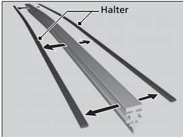
4. Entfernen Sie die Halter vom ausgebauten Wischergummi, und befestigen Sie sie am neuen Wischergummi.
