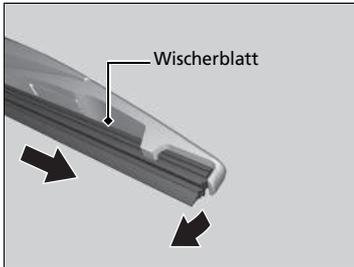
3. Schieben Sie das Scheibenwischerblatt aus dem Ende mit der Kerbe heraus.
