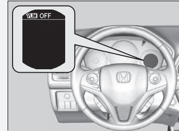
Wenn bei der Verwendung des intelligenten Geschwindigkeitsbegrenzers eine Störung im System oder der Verkehrszeichenerkennung vorliegt, ertönt der Beeper und **AUS** wird angezeigt. Der intelligente Geschwindigkeitsbegrenzer wird ausgeschaltet.
