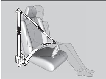
Bei einem mittelschweren bis schweren Frontalzusammenstoß werden die Sicherheitsgurte für die Vordersitze und die äußeren Rücksitze durch die Gurtstraffer automatisch gestrafft. Dies geschieht manchmal sogar dann, wenn der Aufprall nicht schwer genug ist, um die Frontairbags auszulösen.
