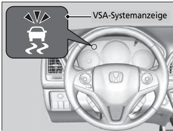
Bei aktivierter VSA kann es vorkommen, dass der Motor nicht auf das Gaspedal reagiert. Es können auch Geräusche aus der Hydraulikanlage hörbar sein. Außerdem blinkt die Anzeige.
