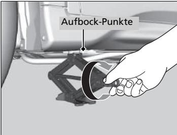
1. Stellen Sie den Wagenheber unter den Hebe punkt, der dem zu wechselnden Reifen am nächsten liegt.
