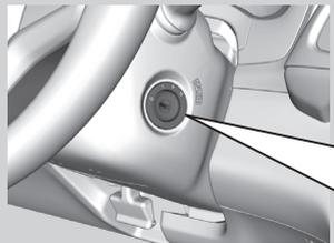
**0** SPERRE: In dieser Stellung wird der Schlüssel eingesteckt und abgezogen.
