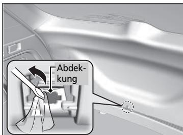
2. Wickeln Sie ein Tuch um die Spitze eines kleinen Schlitzschraubendrehers. Stecken Sie ihn, wie in der Abbildung dargestellt, zum Öffnen der Abdeckung hinein.
