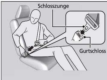
2. Stecken Sie die Schlosszunge in das Gurtschloss und ziehen Sie anschließend am Sicherheitsgurt, um sicherzustellen, dass das Gurtschloss korrekt eingerastet ist.
