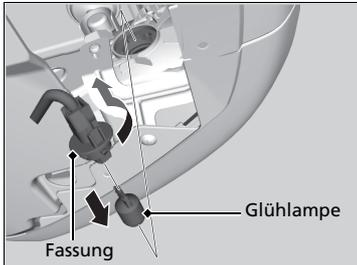
2. Drehen Sie die Fassung nach links und entfernen Sie sie.
