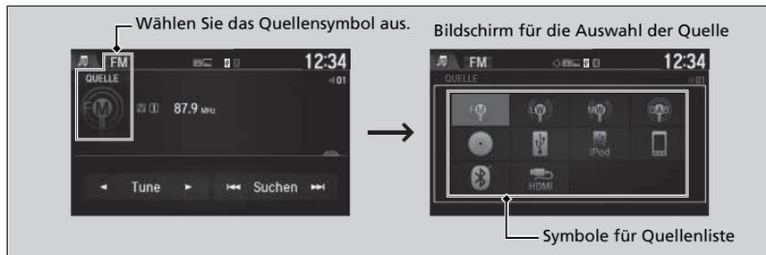
Zum Wechseln der Audioquelle wählen Sie zunächst das Symbol für die aktuelle Quelle und anschließend ein anderes Symbol aus der Quellenliste aus.
