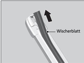
3. Schieben Sie das Scheibenwischerblatt aus der Halterung heraus, indem Sie an dem Ende mit der Lasche ziehen.
