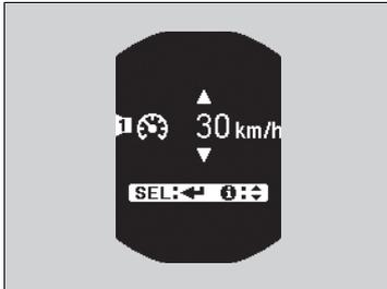
1. Drücken Sie die **▲①/▼**-Taste, bis das Menü des Geschwindigkeitsalarms auf dem Display angezeigt wird, und drücken Sie dann die **SEL/RESET**-Taste.
