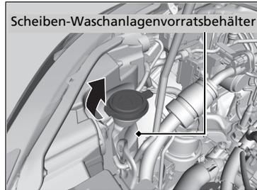
Füllen Sie den Waschanlagenvorratsbehälter bei niedrigem Füllstand nach.
