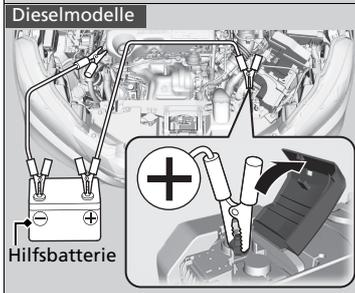
1. Das erste Überbrückungskabel an den  $\oplus$ -Pol Ihres Fahrzeugs anschließen.
