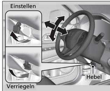
1. Ziehen Sie den Lenkradverstellhebel nach oben.
