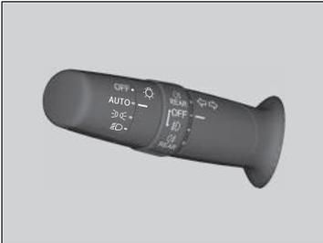
Die automatische Beleuchtungssteuerung kann in der Zündschalterposition ZÜNDUNG EIN verwendet werden \*1.
