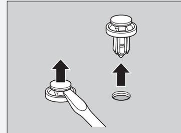
Setzen Sie den Clip mit angehobenem mittlerem Stift ein und drücken Sie, bis dieser flach anliegt.
