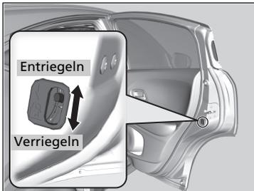
Schieben Sie den Hebel in der Fondtür in die Verriegelungsposition und schließen Sie die Tür.
