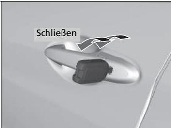
**Schließen:** Die Fahrertür mit dem Schlüssel verriegeln. Drehen Sie den Schlüssel in die Mittelstellung zurück, drehen Sie ihn dann innerhalb von 10 Sekunden wieder in die Verriegelungsstellung und halten Sie ihn in dieser Position.
