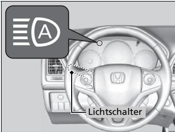
Schalten Sie zum Aktivieren des Systems den Lichtschalter auf **AUTO** und die Scheinwerfer auf Abblendlicht. Die Anzeige des Fernlichtassistenten wird eingeschaltet. Stellen Sie den Scheinwerferhebel auf Abblendlicht.
