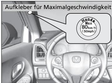
1. Bringen Sie den Aufkleber für die Maximalgeschwindigkeit entsprechend der Abbildung an.
