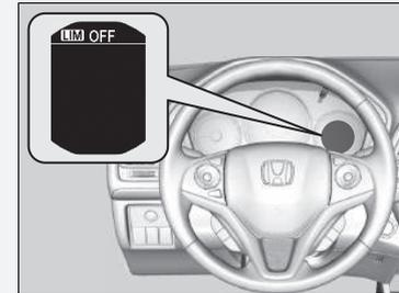
Falls bei aktivem Geschwindigkeitsbegrenzer ein Problem mit dem System vorliegt, ertönt der Warnton und **OFF** leuchtet auf. Der Geschwindigkeitsbegrenzer wird ausgeschaltet.
