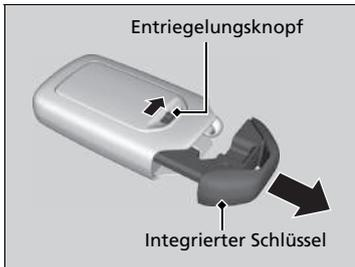
Der integrierte Schlüssel kann zum Ver-/Entriegeln der Türen und der Heckklappe verwendet werden, wenn die Batterie der schlüssellosen Fernbedienung leer und das Ent-/Verriegeln über die Zentralverriegelung nicht mehr möglich ist.
