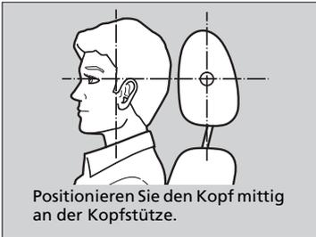
Kopfstützen bieten den bestmöglichen Schutz vor einem Schleudertrauma und anderen Unfallverletzungen, wenn der Hinterkopf mittig an der Mitte der Kopfstütze anliegt. Die optimale Einstellung ist erreicht, wenn sich der obere Bereich der Ohren auf gleicher Höhe mit der Mitte der Kopfstütze befindet.
