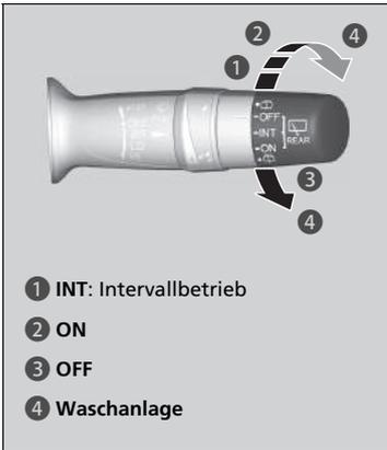
Heckscheibenwischer und -waschanlage können verwendet werden, wenn sich der Zündschalter in der Stellung ZÜNDUNG EIN **II**\*<sup>1</sup> befindet.
