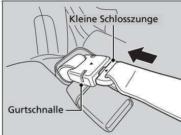
2. Richten Sie die Dreiecksmarkierung auf der kleinen Schloszlunge an der Markierung auf der Gurtschnalle aus. Stellen Sie sicher, dass der Sicherheitsgurt nicht verdreht ist. Befestigen Sie den Sicherheitsgurt an der Gurtschnalle.
