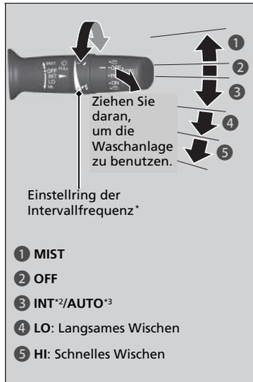
Wisch- und Waschanlage der Windschutzscheibe können in der Schalterposition ZÜNDUNG EIN **II** \*1 der Zündung verwendet werden.
