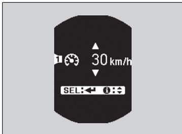
1. Drücken Sie die /▼-Taste, bis das Menü des Geschwindigkeitsalarms auf dem Display angezeigt wird, und drücken Sie dann die **SEL/RESET**-Taste.
