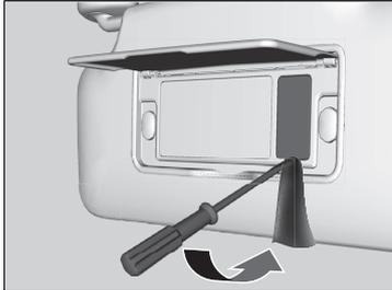
1. Heben Sie die Kante der Abdeckung mit einem Schlitzschraubendreher an, und entfernen Sie die Abdeckung.
