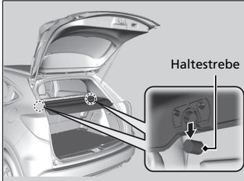
3. Lösen Sie die Stützstreben und entfernen Sie dann die Gepäckraumabdeckung.
