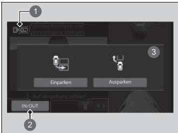
1 Schalter des Parkassistenten Honda Parking Pilot
