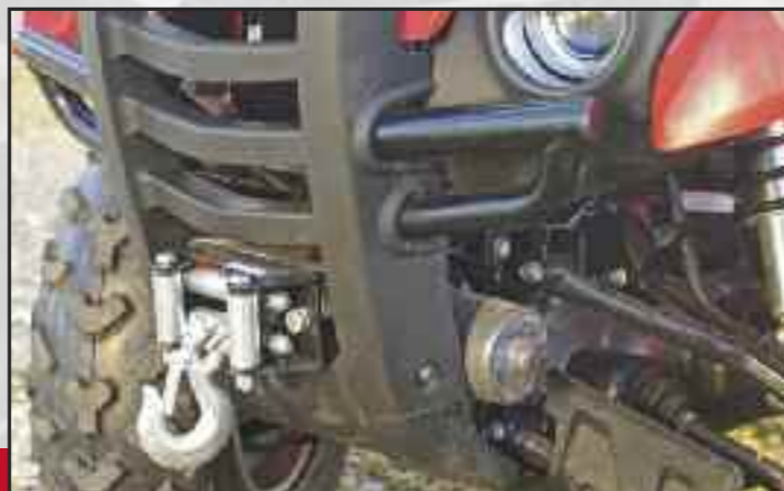
Serienmäßig: 1500-lbs-Seilwinde von Warn mit Rollenfenster
