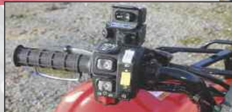
Schalter-Paket: serienmäßig ESP, aufgesattelt Blinker, Hupe und Windensteuerung
