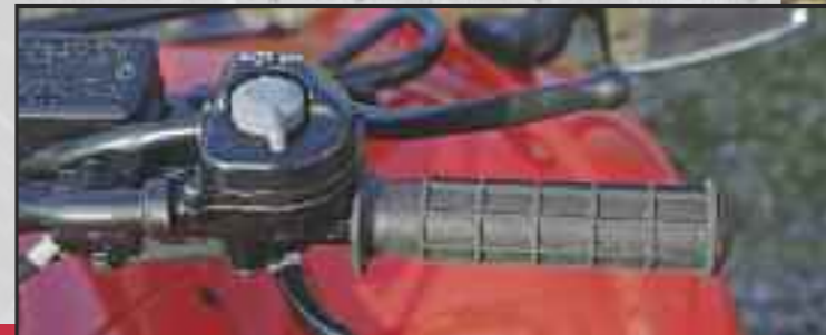
Automatisch oder manuell: Mit dem Drehschalter lässt sich der Schaltmodus vorwählen
