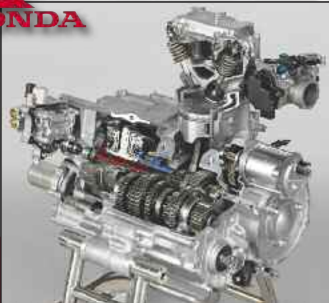
Modern Times: wassergekühlter ATV-Motor mit Doppelkupplungs-Getriebe
