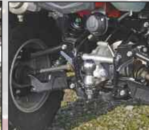
Hinterachse: Einzelradaufhängung mit doppelten A-Arms
