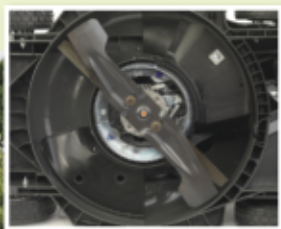
Die Doppelmesser der HRX 537-Rasenmäher können sowohl präzise mähen als auch fein mulchen.
