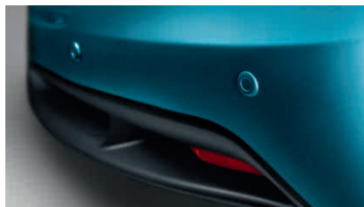
Einparkhilfe hinten in Wagenfarbe lackiert
