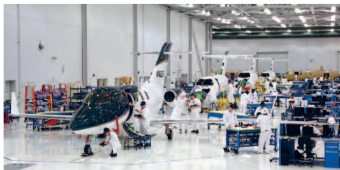
Die Triebwerke der HA-420 sind auf den Flügeln befestigt.
