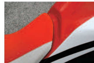
Die Sitzbank lässt sich in zwei Positionen fixieren, was 15 mm Unterschied in der Sitzhöhe ausmacht.
