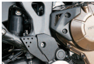
Kunststoffprotektoren an Rahmen und Kupplungsglocke, angeschweißtes Rahmenheck.
