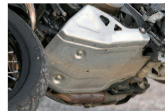
Stabiler Alu-Motorschutz serienmäßig, kein Hauptständer. Die Krümmer haben separate Schutzbleche.
