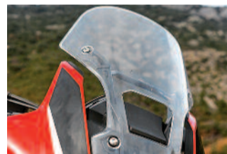
Knappe Scheibe mit erstaunlich gutem Windschutz und geringe Verwirbelungen dank schlauer Öffnungen.
