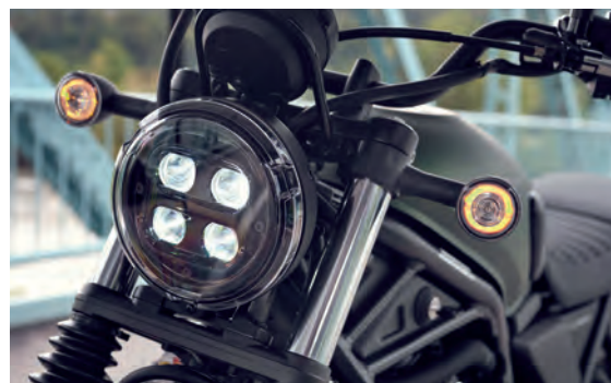
Der LED-Scheinwerfer der neuen Honda CL500 stammt eins zu eins von der CMX500 Rebel. Vier LED-Linsen sorgen für eine charakteristische Lichtsignatur.
