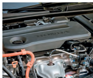
Dreimotoriger e:HEV-Antrieb mit 135 kW und 315 Nm Drehmoment.
