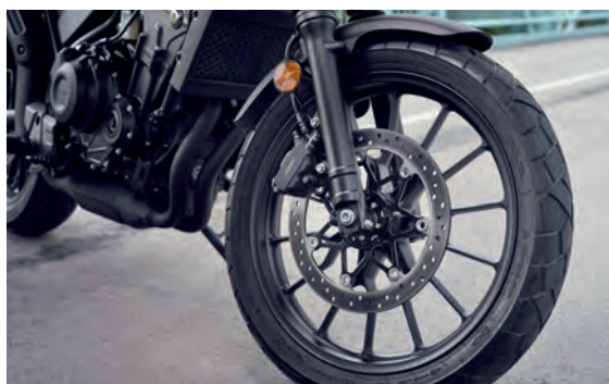
19 Zoll misst die vordere Aluminiumgussfelge, 17 Zoll sind es hinten. Vorn greift eine schwimmend gelagerte 2-Kolben-Bremssattel nach der 310-mm-Scheibe, hinten packt sich eine Einkolben-Bremssattel die 240-mm-Bremsscheibe.
