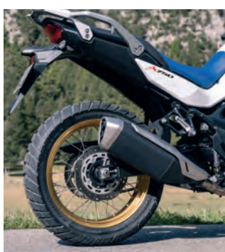
Die Schwinge wächst in der Länge und erlaubt mit Pro-Link-Federbein 190 Millimeter Federweg.
