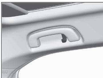
An den Haltegriffen hinten links und hinten rechts befinden sich Kleiderhaken.
