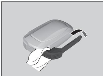
2. Entfernen Sie die Oberseite der Abdeckung durch vorsichtiges Aufstemmen am Schlitz mit dem Schlüsselgriff.
