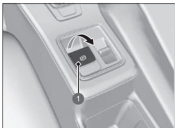
1 Schalter für die elektrische Feststellbremse
