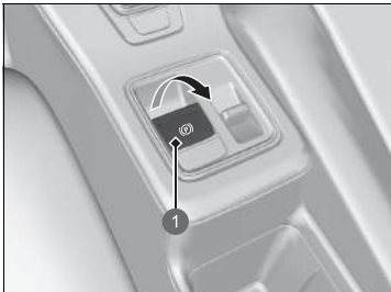
1 Schalter für die elektrische Feststellbremse
