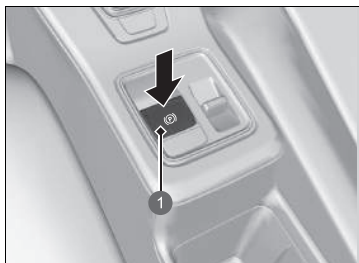
1 Schalter für die elektrische Feststellbremse
