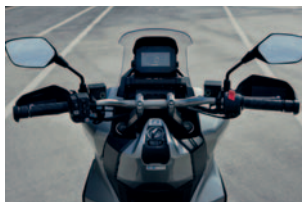
Die Kommandozone des Honda ADV350: breiter Lenker im Adventure-Style, mehrfach verstellbarer Windschild, Negativ-Display aus dem Konzernregal.
