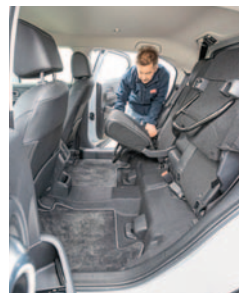
KONSTRUIERT und das sehr schlau: Hochklappbare Bank, so passt ein Fahrrad rein.
